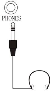
您可以将一个标准的立体声耳机插入本琴的PHONES耳机/辅助输出连接上，当耳机与这个接口连接后，本琴的内部扬声器线路自动断开，只有从耳机中才能听到演奏声，这样，您可以在不干扰别人的情况下进行演奏练习。
