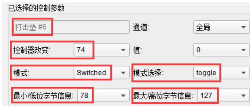
第一次按6号打击垫将发送#74指令，值为78，此操作将部分关闭滤波但仍将允许大部分音频通过。第二次按6号打击垫将发送值127，完全打开滤波器。注意：确保MIDI通道的设置以便使其能和接收设备匹配。
