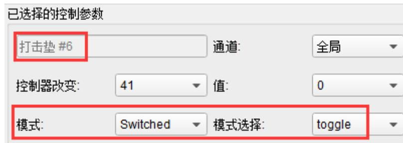
这些设置可用于当你敲击某个打击垫时发送某个MIDI控制器号的两个不同的值。有很多个MIDI控制器号可用于分配至控制此类操作。以下以74号控制器为例。
